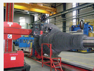
Rys. 7. Stanowisko do spawania wirników turbin
