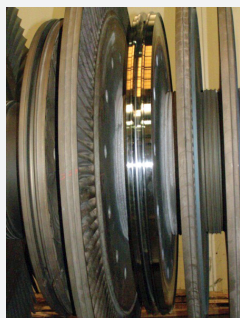
Rys. 8. Odbudowany wręb łopatkowy
