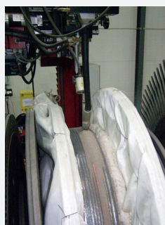
Rys. 6. Odbudowa tarczy wirnika metodą spawania
